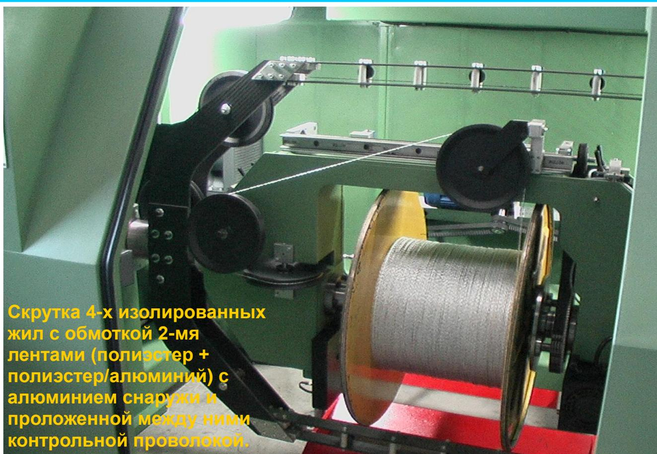
**Скрутка 4-х изолированных жил с обмоткой 2-мя лентами (полиэстер + полиэстер/алюминий) с алюминием снаружи и проложенной между ними контрольной проволокой.**
